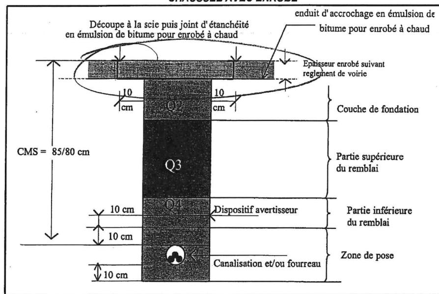
**SOUS ACCOTEMENT inférieur ou égal à 1 mètre de la chaussée**
